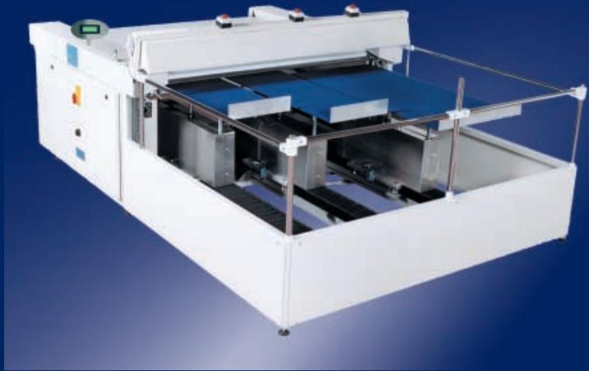
unidad de descargo y apilamiento de los trozos termoadhesivados en salida de las máquinas serie OPEN TOP.
